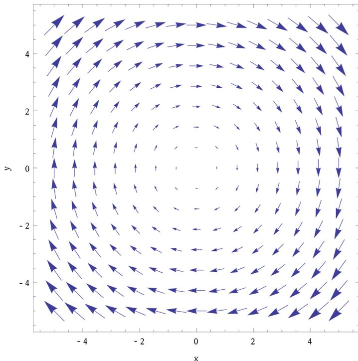
x-y-Querschnitt des Geschwindigkeitsfeldes einer zylindersymmetrischen Strömung
